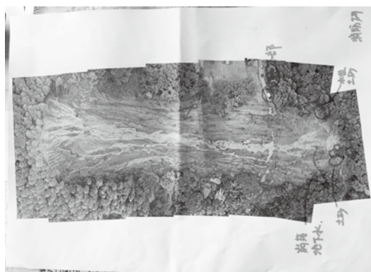
図3 現場指揮本部に提供した崩壊全体の鉛直空撮画像 (7枚の画像を結合、歪み有)
